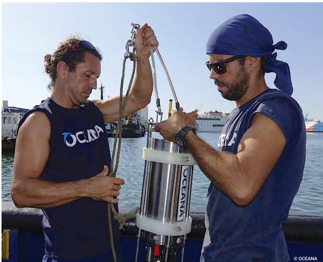
Figure 20. Capteurs CTD permettant l'analyse de la colonne d'eau
